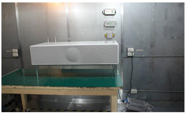
**RADIATED EMISSION TEST**
