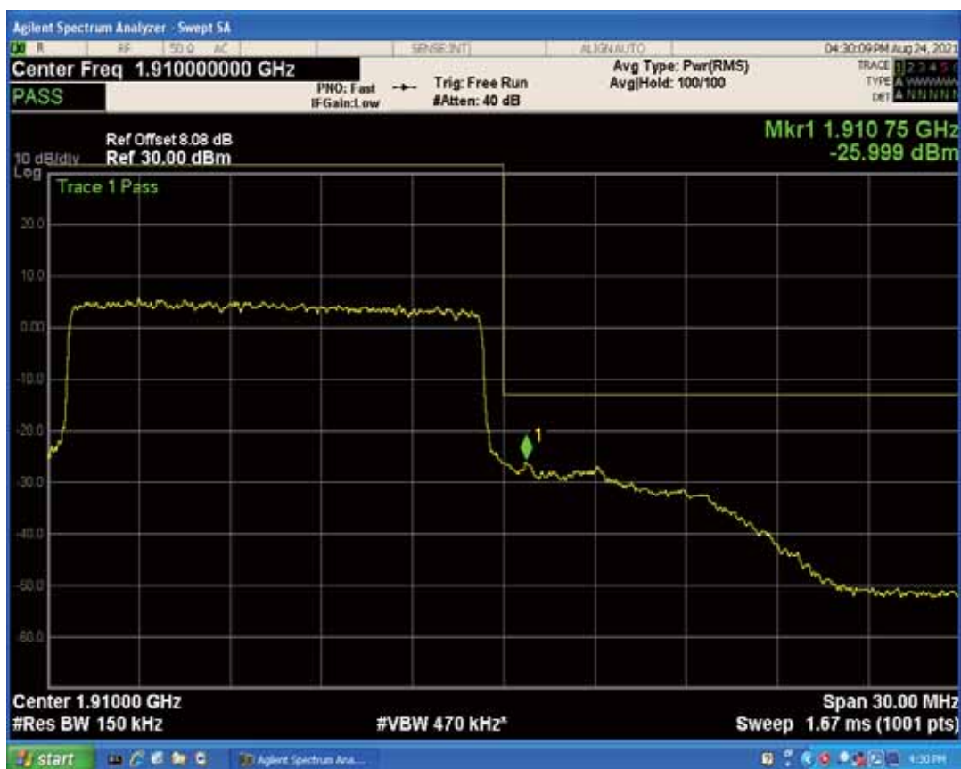
Band2 QPSK BW=20MHz Channel=18700 RB Size=1 Position=#0
