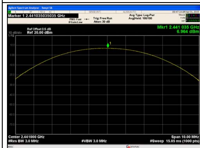
\pi/4 DQPSK Output power - Mid CH 2441
