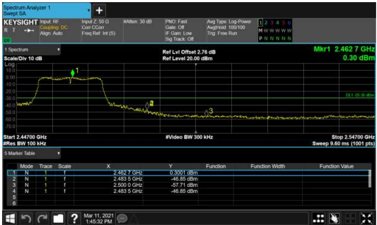
Band Edge NVNT n40 2422MHz Ant1 Ref
