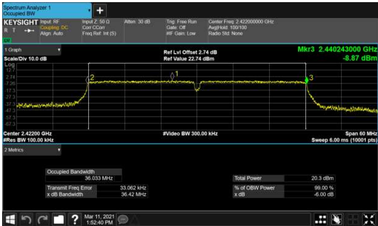
-6dB Bandwidth NVNT n40 2437MHz Ant1
