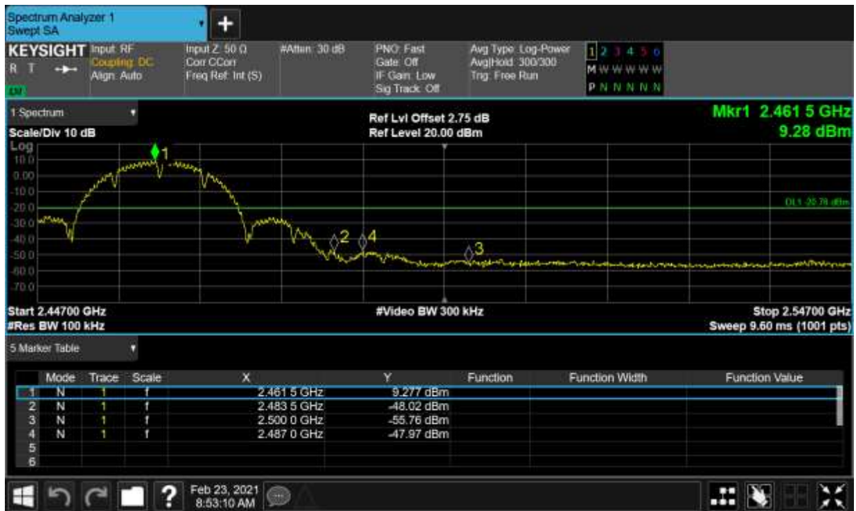
Band Edge NVNT b 2412MHz Ant2 Ref
