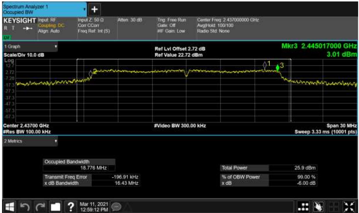
-6dB Bandwidth NVNT g 2462MHz Ant1
