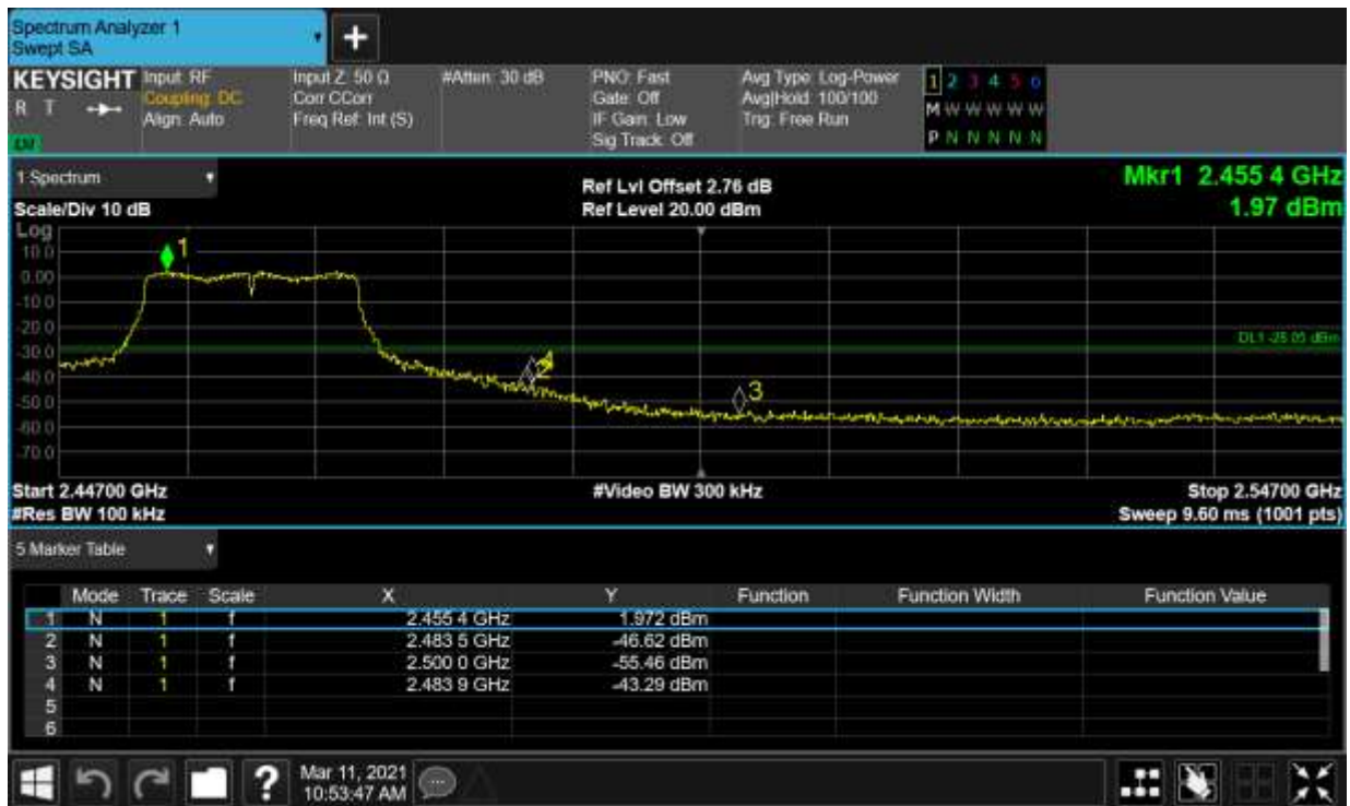
Band Edge NVNT n20 2412MHz Ant1 Ref
