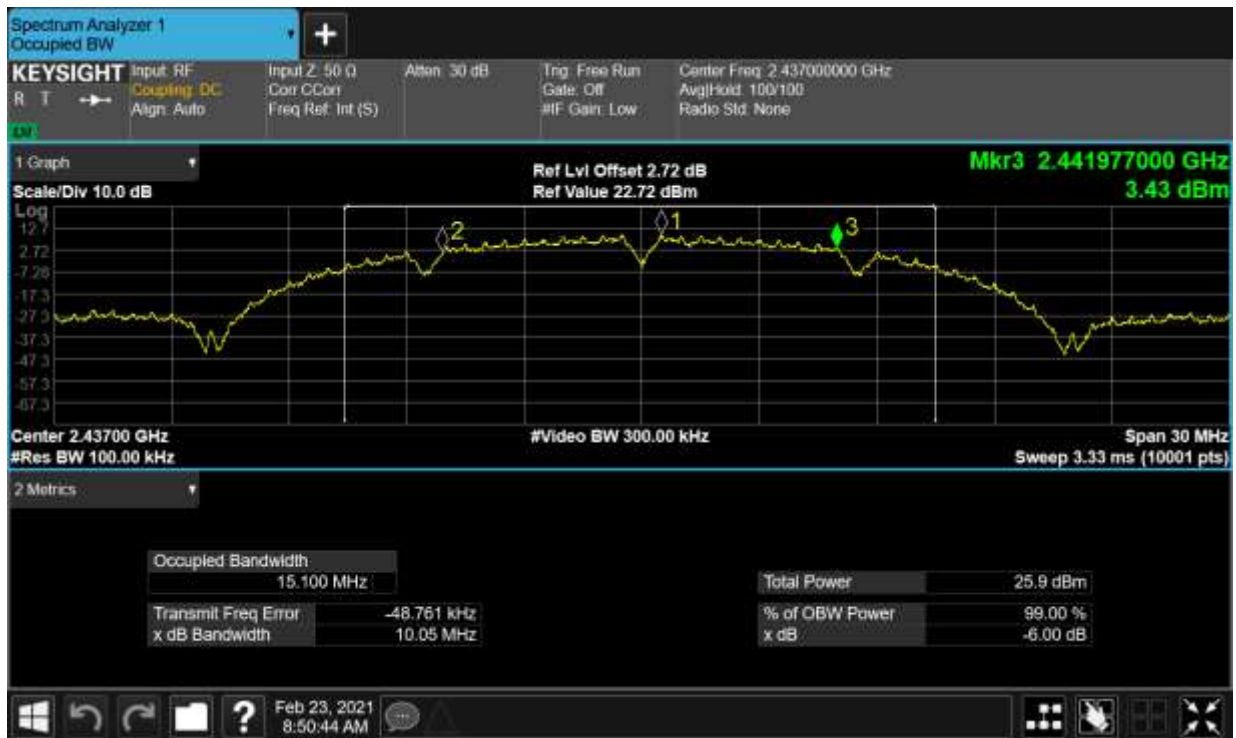
-6dB Bandwidth NVNT b 2462MHz Ant1
