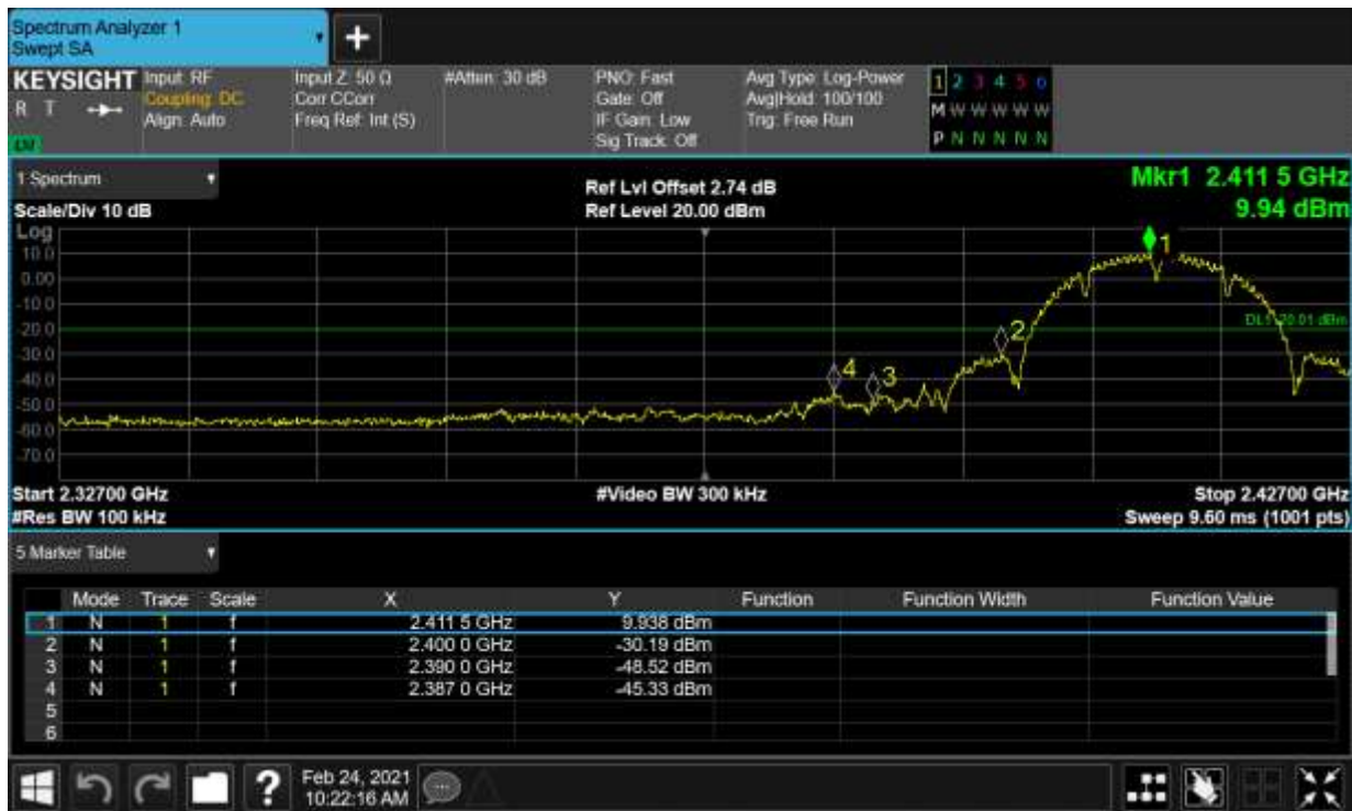
Band Edge NVNT b 2462MHz Ant2 Ref
