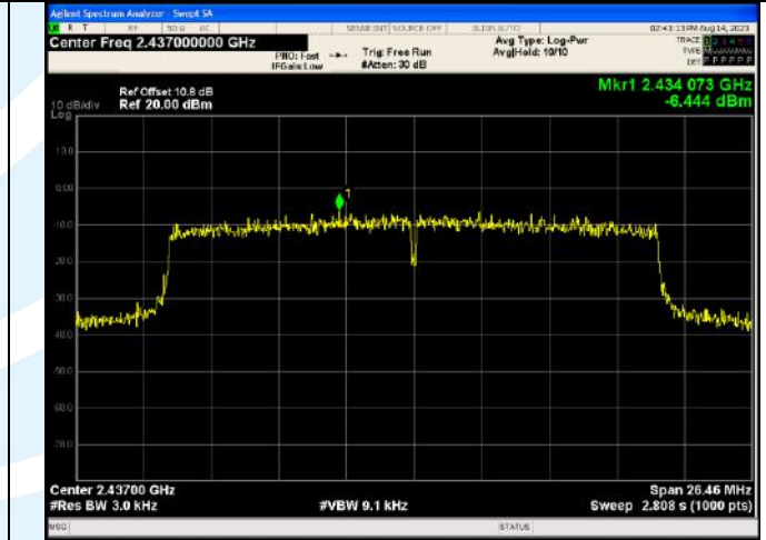
IEEE 802.11ax Channel 6_20MHz_ Antenna 1_RU&amp;Index SU
