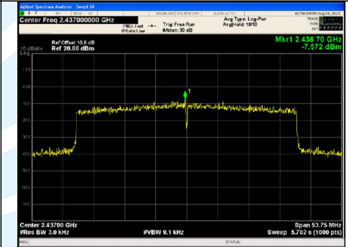
IEEE 802.11ax_Channel 6_40MHz_Antenna 1_RU&amp;Index SU
