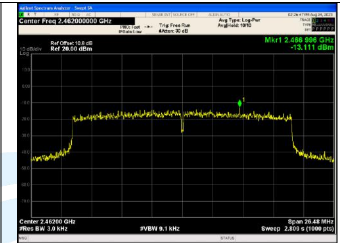
IEEE 802.11ax_Channel 11_20MHz_Antenna 1_RU&amp;Index SU
