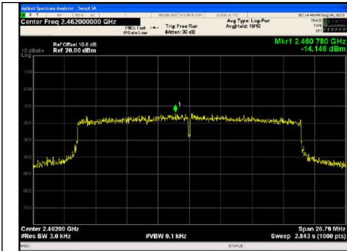
IEEE 802.11ax_Channel 11_20MHz_Antenna 0_RU&amp;Index SU
