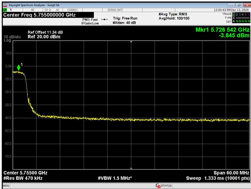
**PSD 802.11ac(VHT40) 5755MHz**
