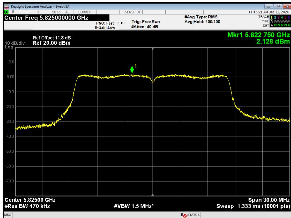
**PSD 802.11ac(VHT20) 5720MHz**
