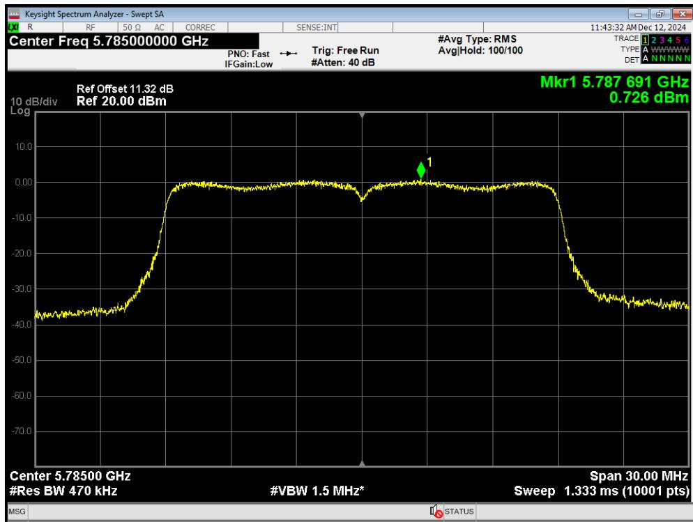
**PSD 802.11ac(VHT20) 5825MHz**
