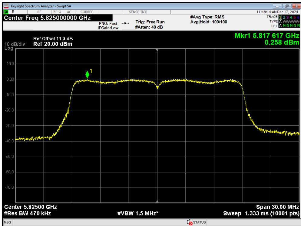
**PSD 802.11ac(VHT40) 5710MHz**
