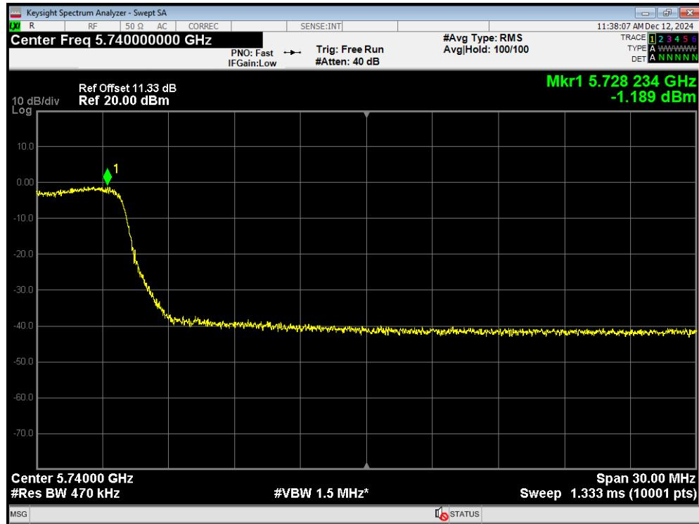
**PSD 802.11ac(VHT20) 5745MHz**
