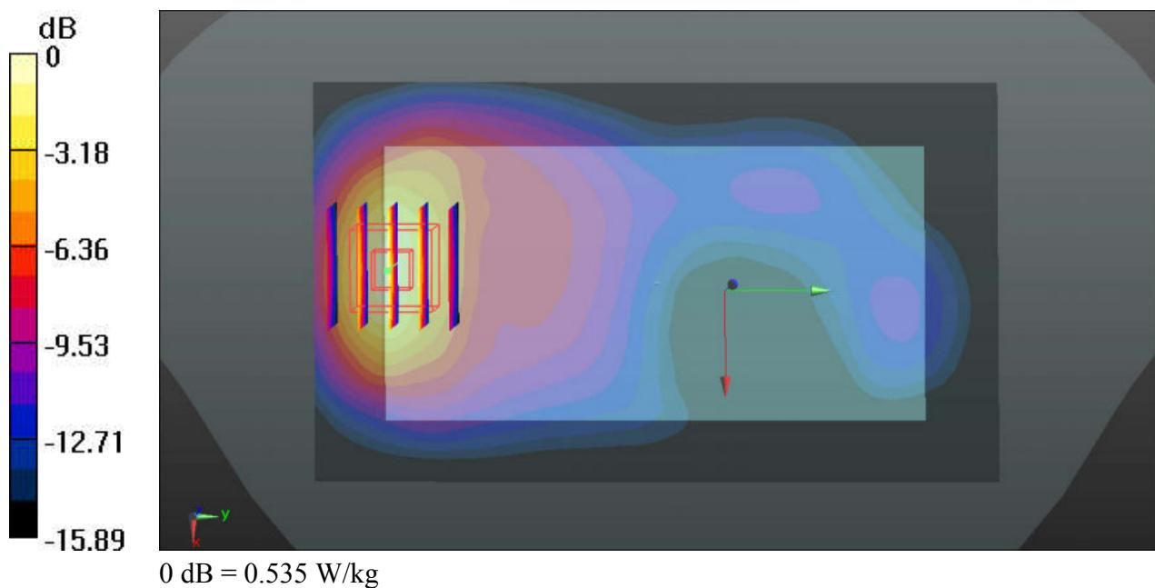
**23\_LTE Band 7\_20M\_QPSK\_1RB\_99Offset\_Back\_10mm\_Ch21350**
