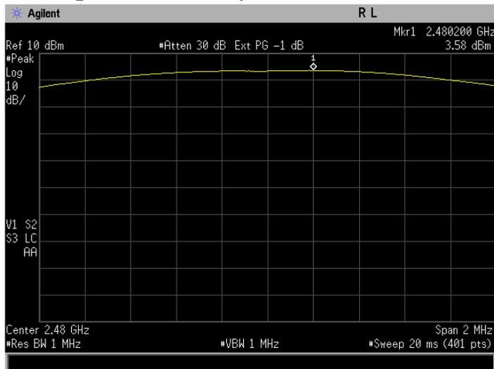
**Figure 5-3a: Peak Output Power, EDR DQPSK Channel 78.**
