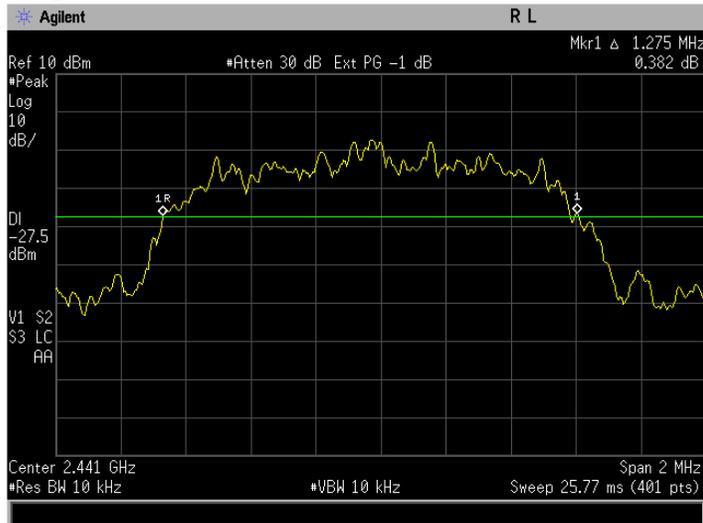
**Figure 6-2b: 20dB Bandwidth EDR DQPSK, Channel 39.**
