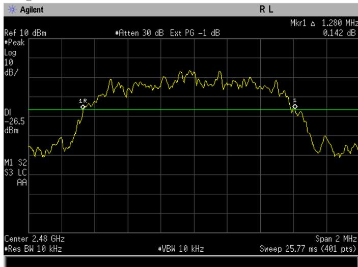
**Figure 6-3b: 20dB Bandwidth EDR DQPSK, Channel 78.**
