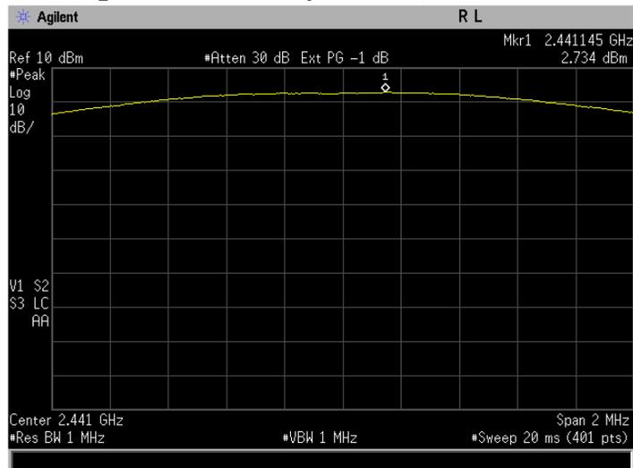
**Figure 5-2a: Peak Output Power, EDR DQPSK Channel 39.**
