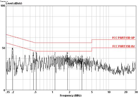
: Shielding Room : CISPR22- CLASS B QP CE NEUTRAL : MOBILE PRINTER Condition
