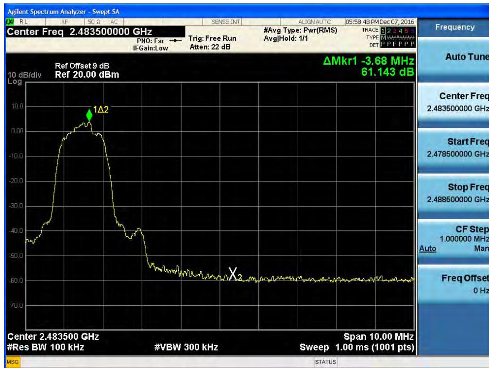
Test Plots without hopping ( $\pi/4$ DQPSK)
