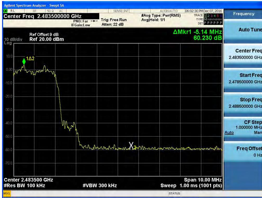
Test Plots with hopping ( $\pi/4$ DQPSK)
