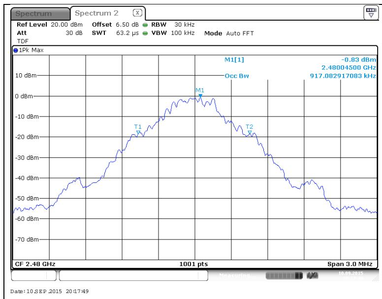
\*  $\pi/4$ DQPSK (Occupied Bandwidth)
