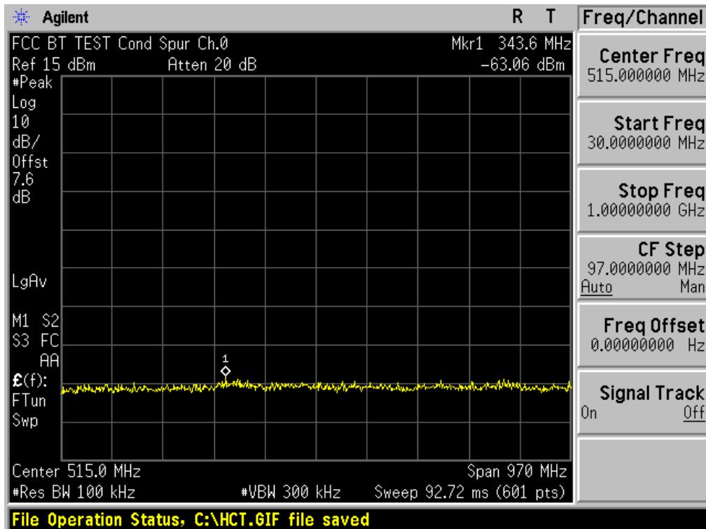
Test Plots ( $\pi/4$ DQPSK) - 30 MHz - 1 GHz (RBW:100 kHz, VBW: 300 kHz)
