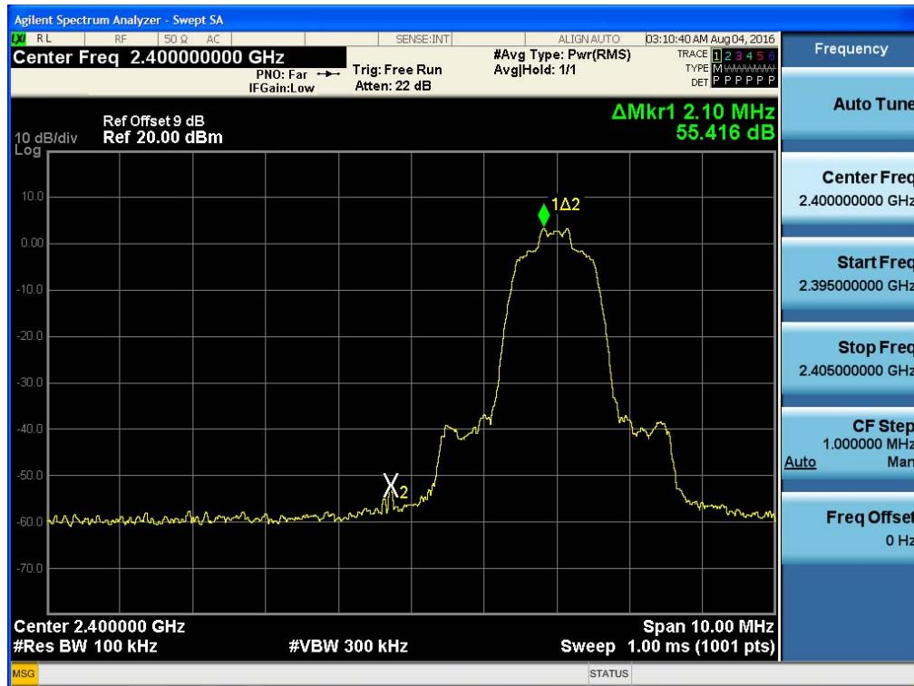
Test Plots without hopping ( $\pi/4$ DQPSK)
