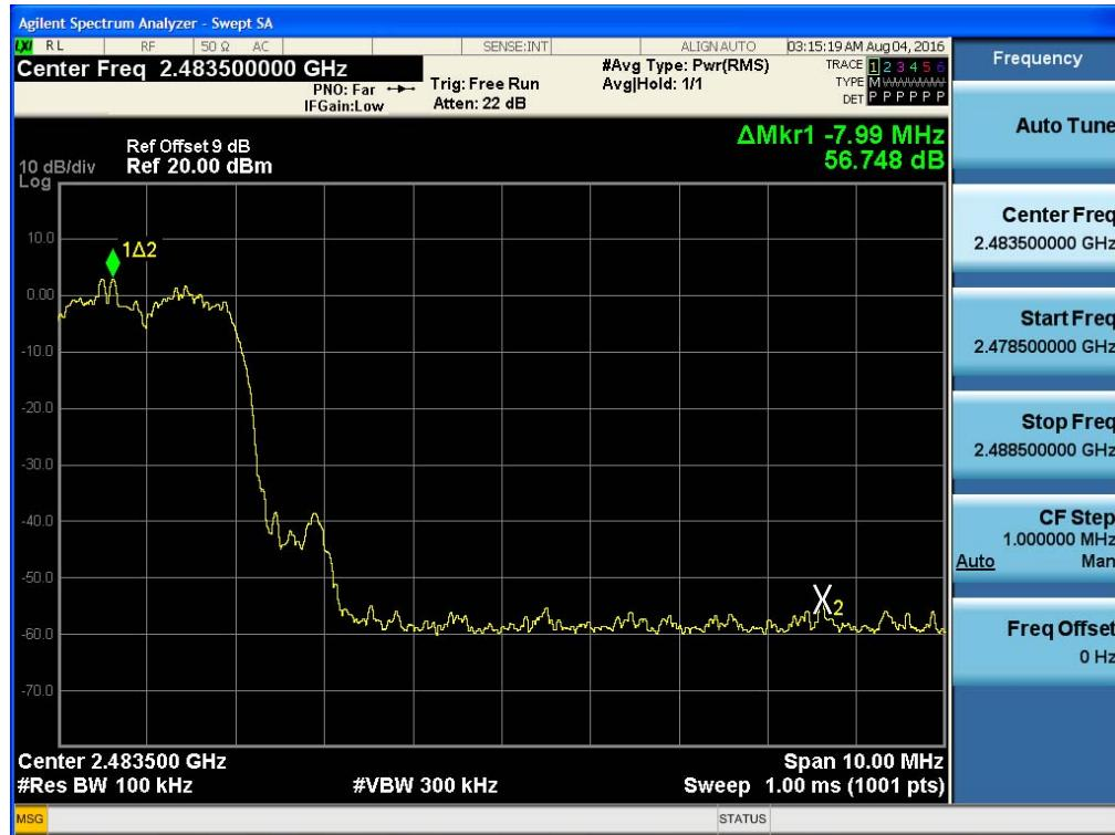
Test Plots with hopping ( $\pi/4$ DQPSK)
