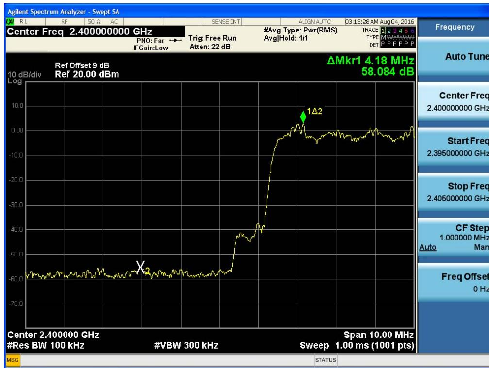
Test Plots with hopping ( $\pi/4$ DQPSK)
