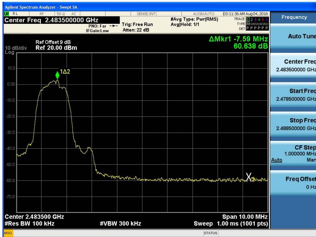
Test Plots without hopping ( $\pi/4$ DQPSK)
