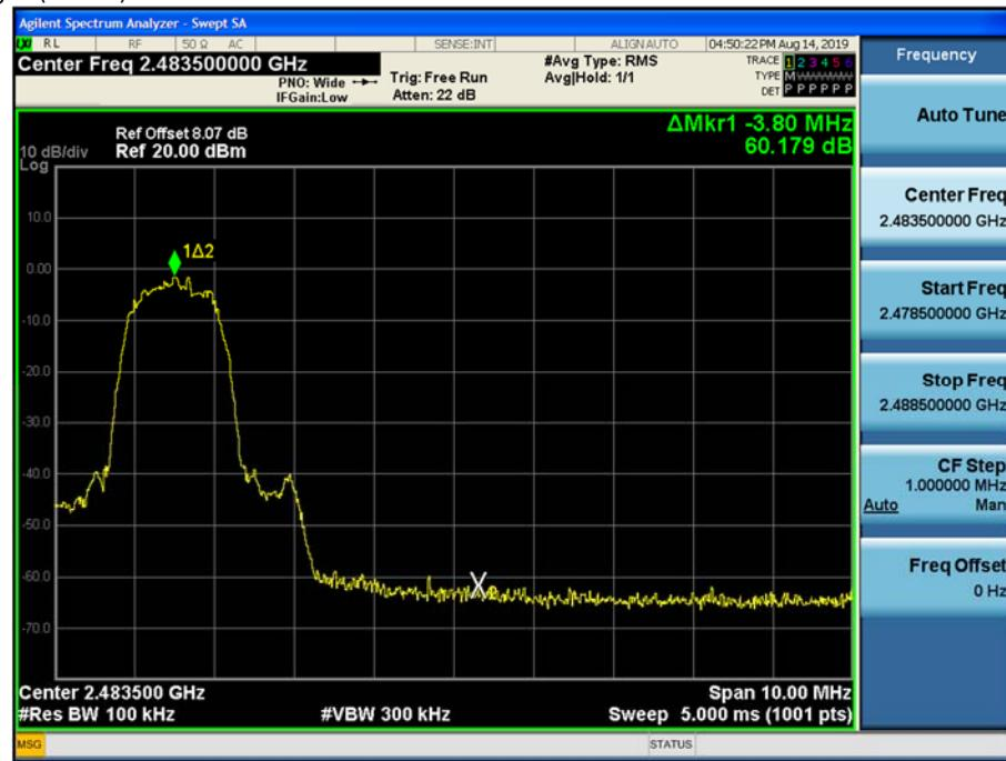
Test Plots without hopping ( $\pi/4$ DQPSK)
