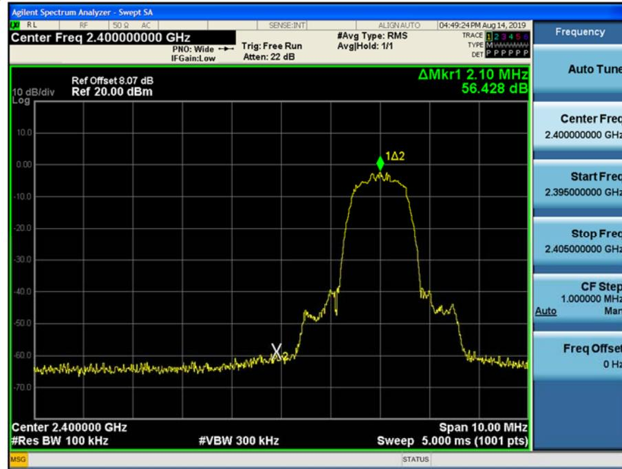
Test Plots without hopping ( $\pi/4$ DQPSK)
