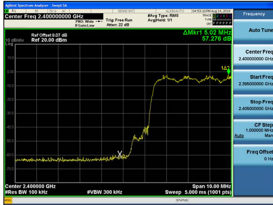
Test Plots with hopping ( $\pi/4$ DQPSK)
