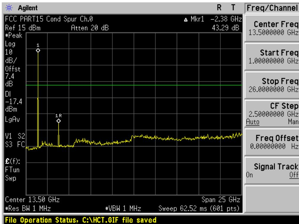
Test Plots ( $\pi/4$ DQPSK) - 1 GHz - 26 GHz (RBW:1 MHz, VBW: 1 MHz)
