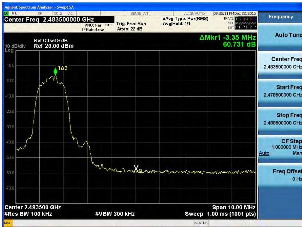
Test Plots without hopping ( $\pi/4$ DQPSK)
