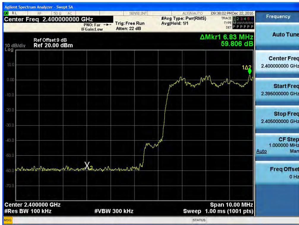
Test Plots with hopping ( $\pi/4$ DQPSK)
