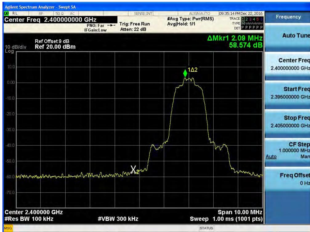
Test Plots without hopping ( $\pi/4$ DQPSK)
