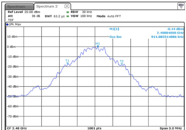
**-  $\pi/4$ DQPSK (Occupied Bandwidth)**
