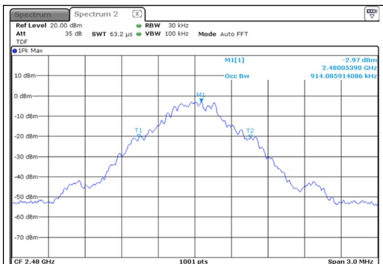
\*  $\pi/4$ DQPSK (Occupied Bandwidth)
