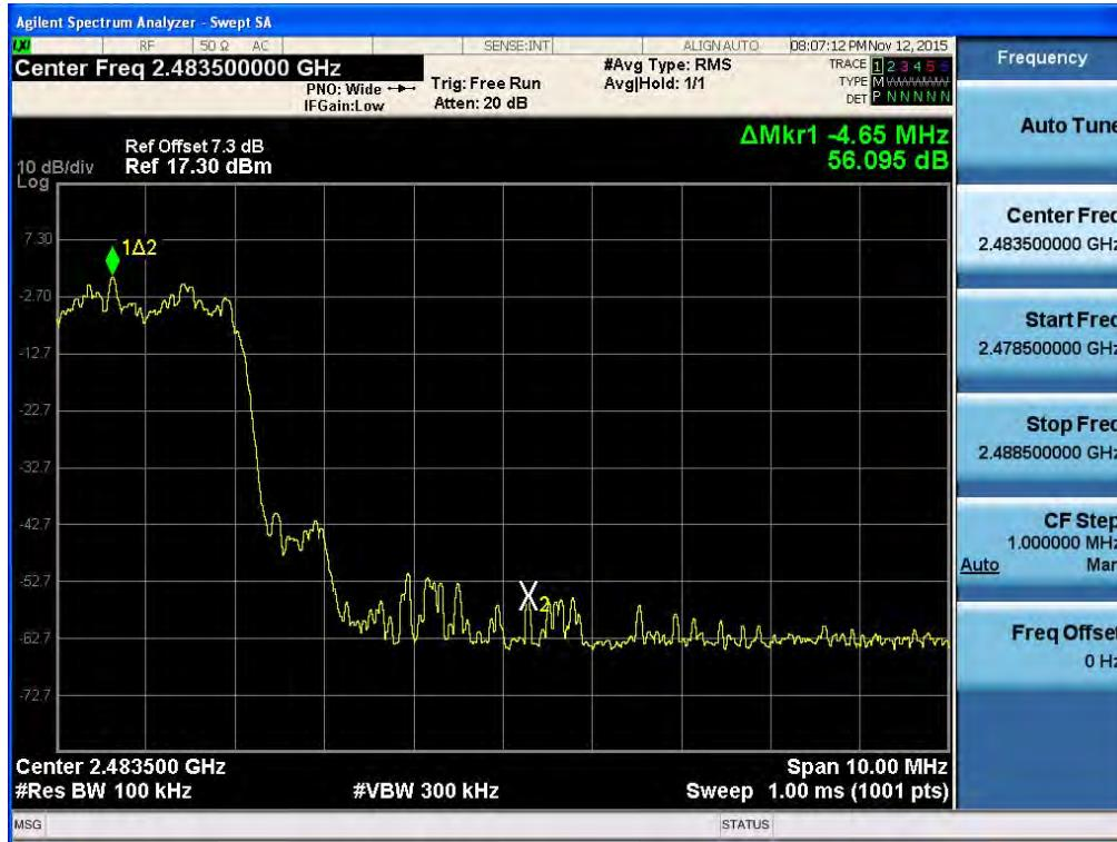
Test Plots with hopping ( $\pi/4$ DQPSK)
