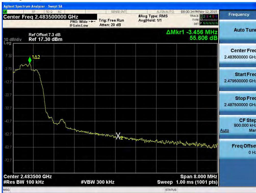
Test Plots without hopping ( $\pi/4$ DQPSK)
