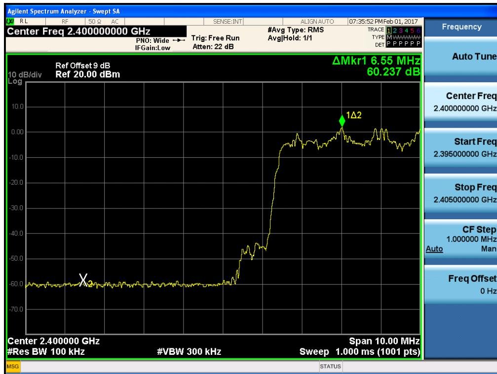
Test Plots with hopping ( $\pi/4$ DQPSK)
