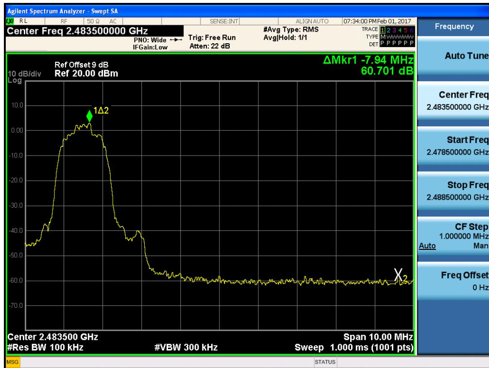
Test Plots without hopping ( $\pi/4$ DQPSK)
