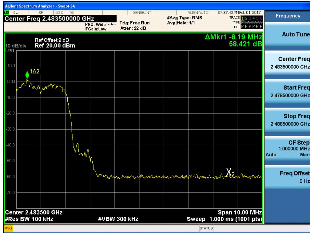
Test Plots with hopping ( $\pi/4$ DQPSK)
