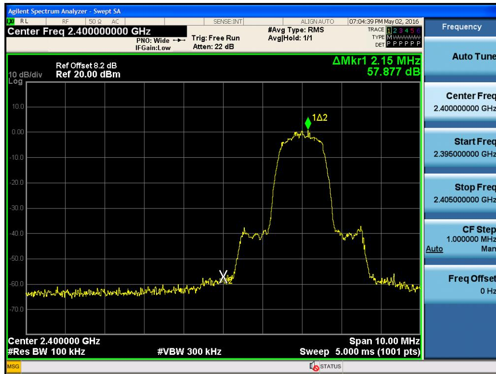
Test Plots without hopping ( $\pi/4$ DQPSK)
