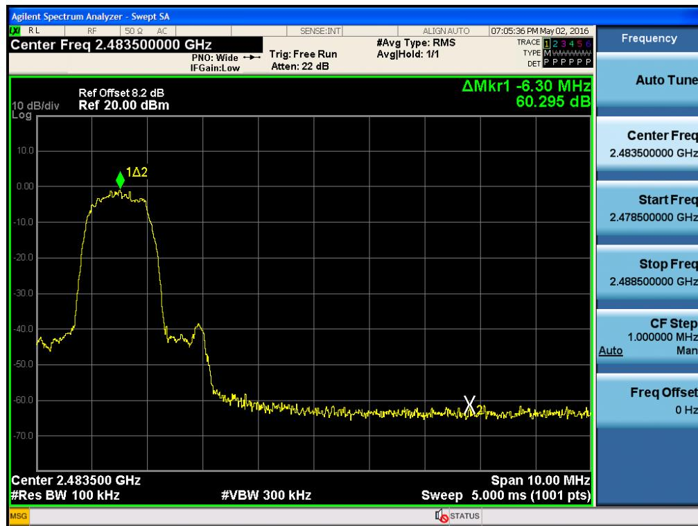
Test Plots without hopping ( $\pi/4$ DQPSK)
