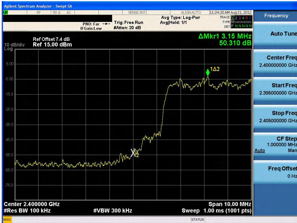
Test Plots with hopping ( $\pi/4$ DQPSK)
