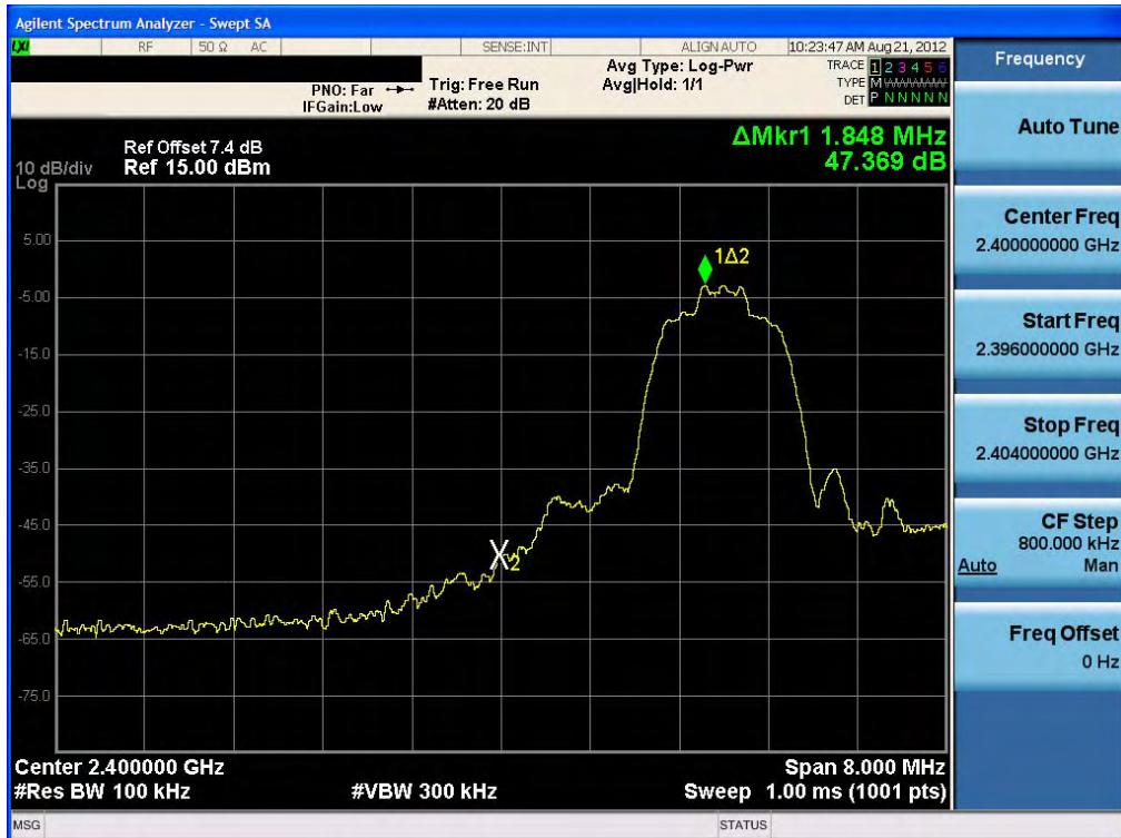
Test Plots without hopping ( $\pi/4$ DQPSK)
