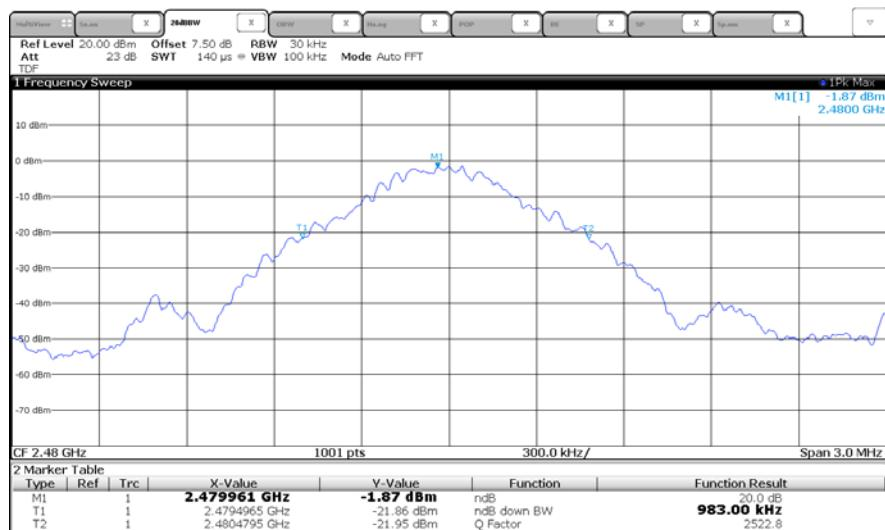
\*  $\pi/4$ DQPSK (20 dB Channel Bandwidth)
