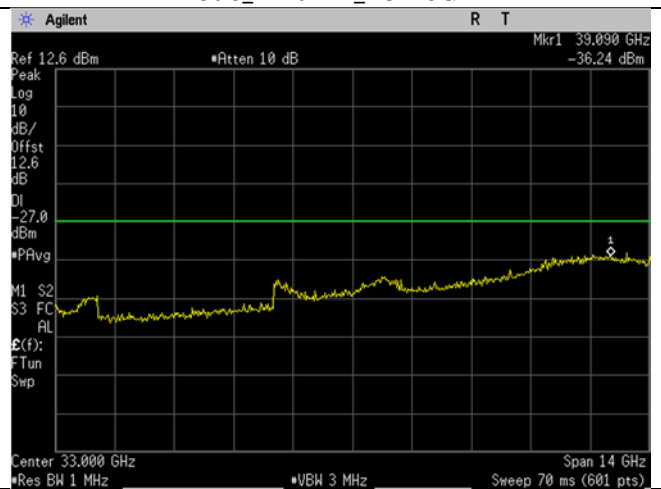
U-NII-2C_5610MHz_Mid Ch_122_80MHz BW_ac-mode_-27dBm_26-40GHz
