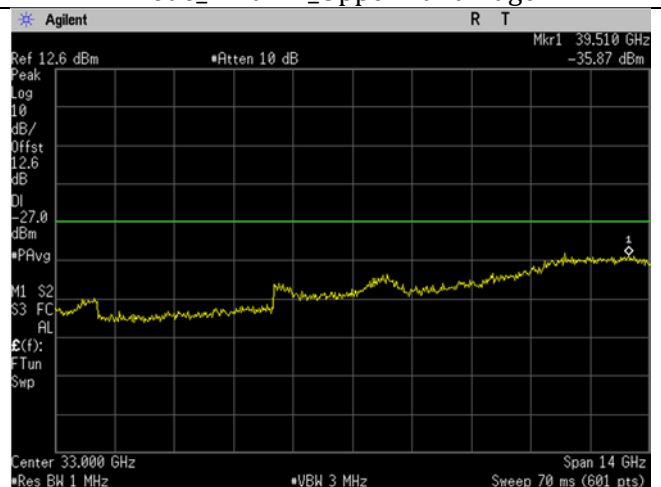
U-NII-2C_5500MHz_Low Ch_100_20MHz BW_a-mode_-27dBm_26-40GHz
