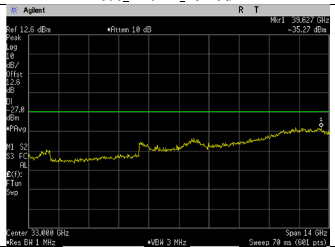
U-NII-2C_5720MHz_High Ch_144_20MHz BW_n/ac-mode_-27dBm_26-40GHz
