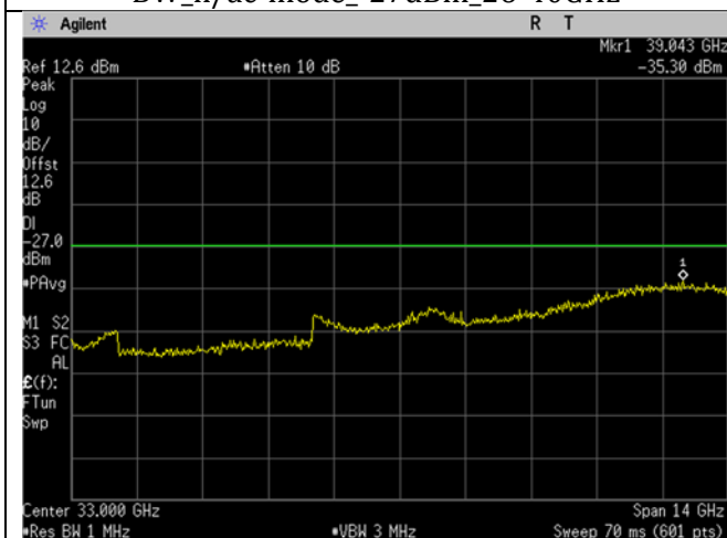
U-NII-1_5210MHz_Low Mid Ch_42_80MHz BW_ac- mode_-27dBm_26-40GHz
