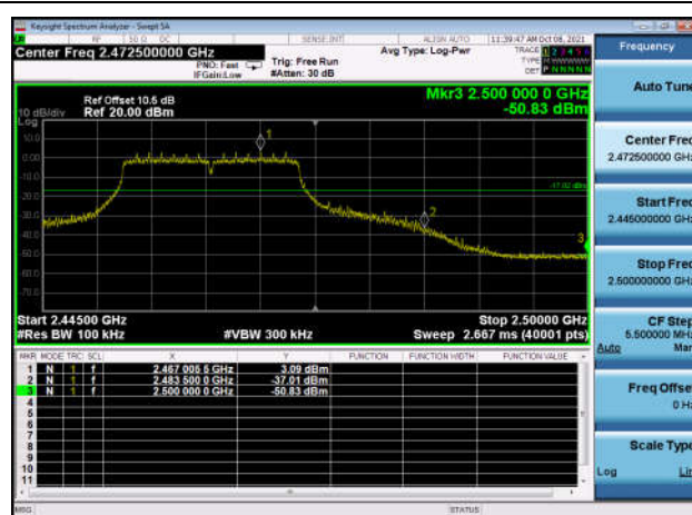
,Plot 2,Band Edge-802.11n(HT20) ,2462MHz,Ant0
