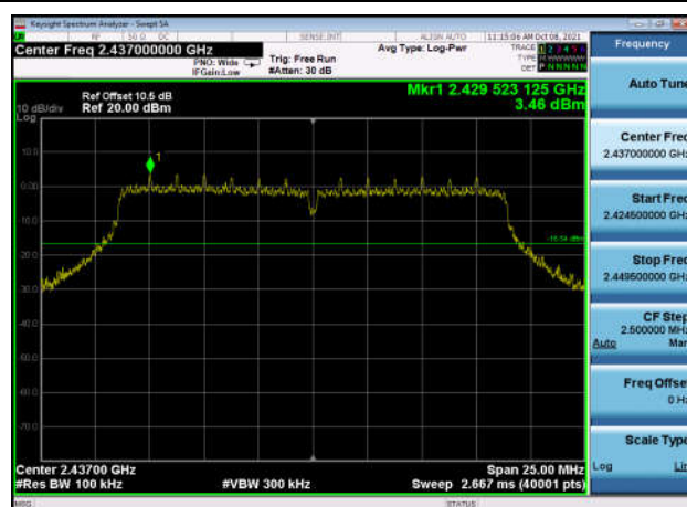
,Plot 2,Band Edge-802.11n(HT20) ,2412MHz,Ant0
