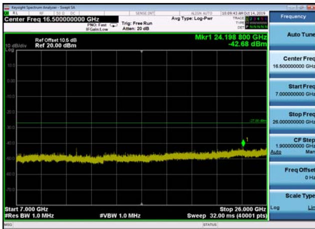
U-NII-3 ,Plot 4,7000MHz~26000MHz-802. 11n(20MHz),5825MHz,Ant1
