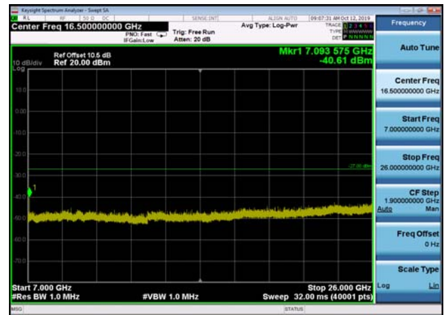
U-NII-2a ,Plot 1,Band Edge-802.11n(40 MHz),5270MHz,Ant2
