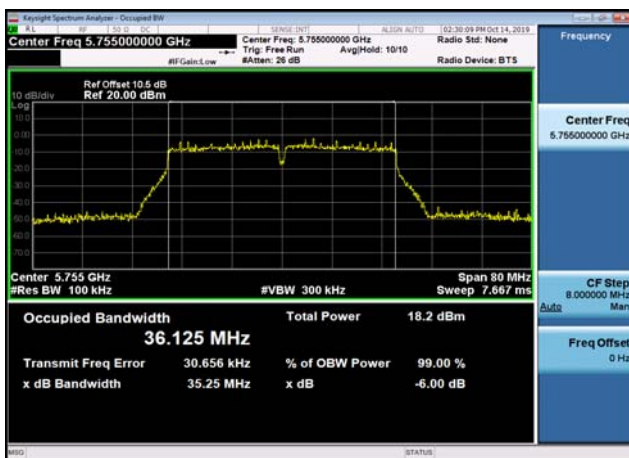
U-NII-3 6dB Bandwidth-802.11n(40MHz) ,5755MHz,Ant1
