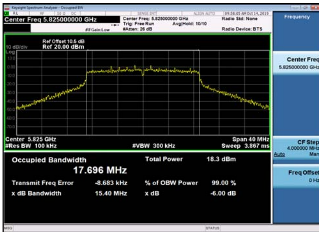
U-NII-3 6dB Bandwidth-802.11n(40MHz) ,5755MHz,Ant1
