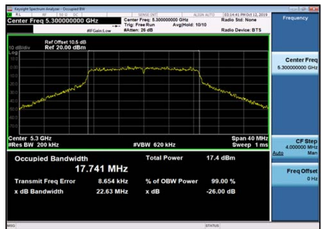
U-NII-2a 26dB Bandwidth-802.11ac(20MHz),5320MHz,Ant2
