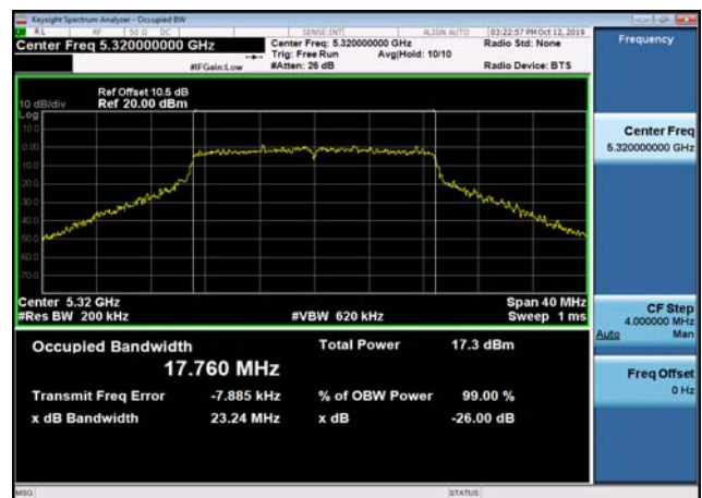
U-NII-2a 26dB Bandwidth-802.11ac(20MHz),5320MHz,Ant2
