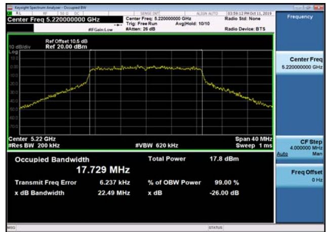
U-NII-1 26dB Bandwidth-802.11ac(20MHz) ,5240MHz,Ant2
