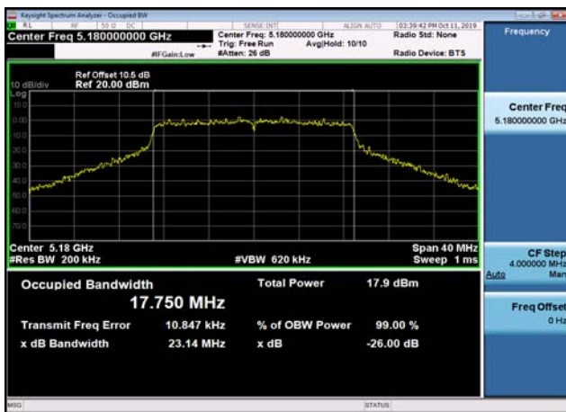
U-NII-1 26dB Bandwidth-802.11ac(20MHz) ,5180MHz,Ant1
