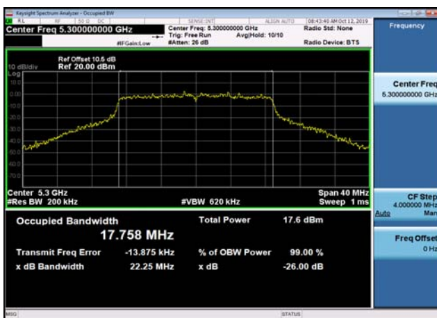
U-NII-2a 26dB Bandwidth-802.11n(20MHz) ,5300MHz,Ant1
