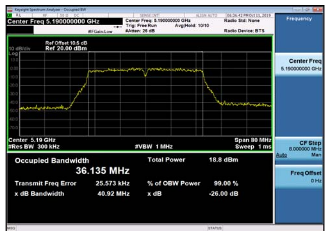
U-NII-1 26dB Bandwidth-802.11ac(40MHz) ,5190MHz,Ant2
