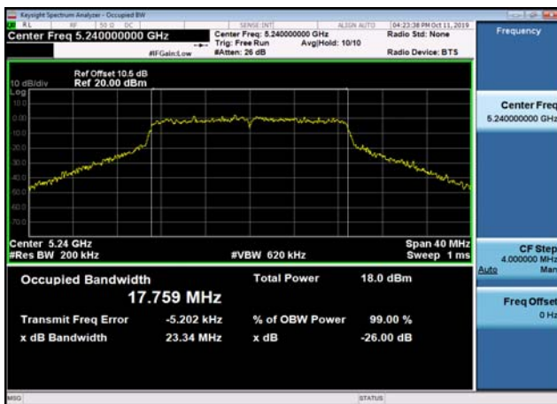
U-NII-1 26dB Bandwidth-802.11ac(40MHz) ,5190MHz,Ant1
