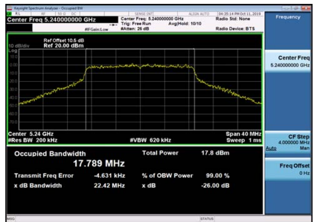
U-NII-1 26dB Bandwidth-802.11ac(40MHz) ,5190MHz,Ant2
