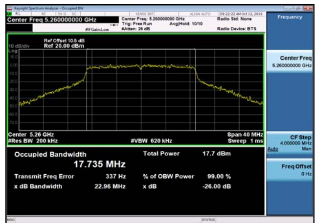
U-NII-2a 26dB Bandwidth-802.11n(20MHz) ,5300MHz,Ant2
