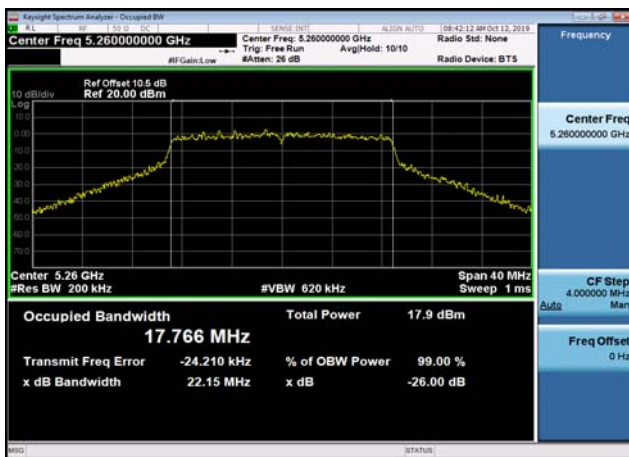
U-NII-2a 26dB Bandwidth-802.11n(20MHz) ,5300MHz,Ant1
