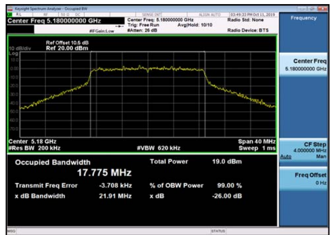
U-NII-1 26dB Bandwidth-802.11ac(20MHz) ,5180MHz,Ant2
