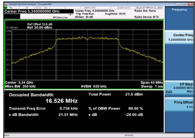
U-NII-1 26dB Bandwidth-802.11ac(20MHz) ,5180MHz,Ant2
