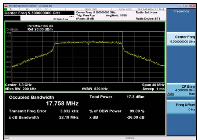
U-NII-2a 26dB Bandwidth-802.11n(20MHz) ,5300MHz,Ant2
