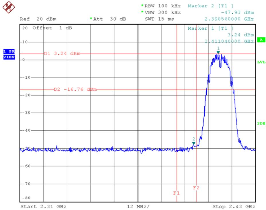
802.11b - Low Band Edge Plot on Channel 1
