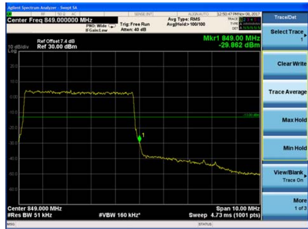
LTE Band 5 QPSK 10MHz CH-High 1RB
