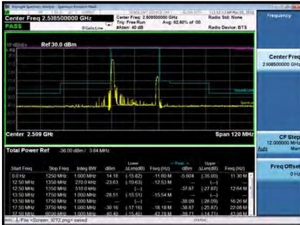
CA\_41C QPSK 20MHz+5MHz CH- High, RB 1
