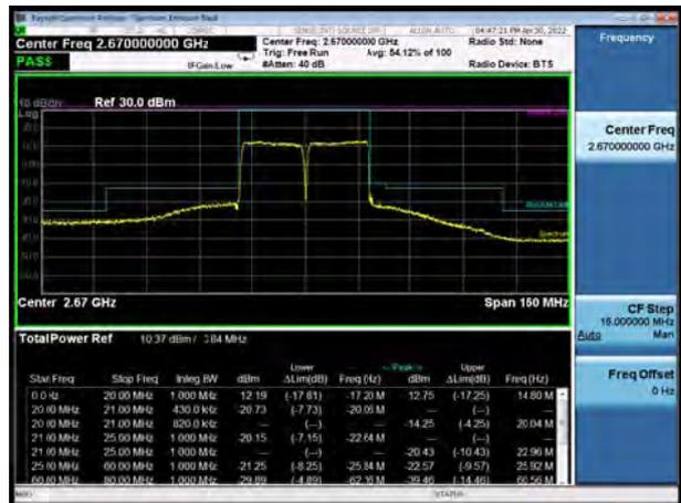
CA\_41C 16QAM 20MHz+20MHz CH-Low, RB 1
