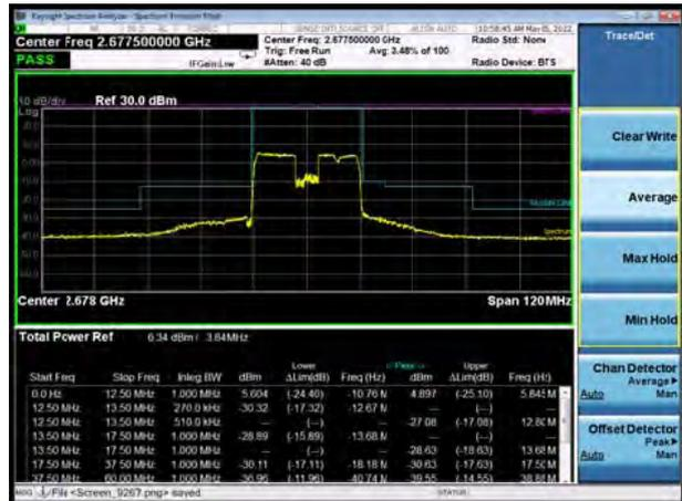
CA\_41C 64QAM 20MHz+5MHz CH-Low, RB 1
