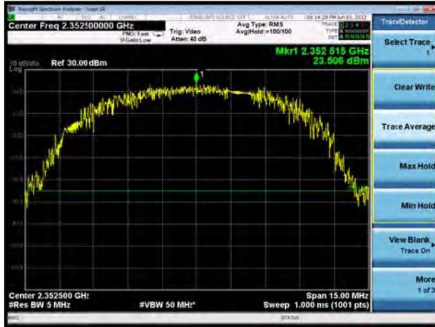
LTE Band 40 Subset 2 64QAM 10MHz
