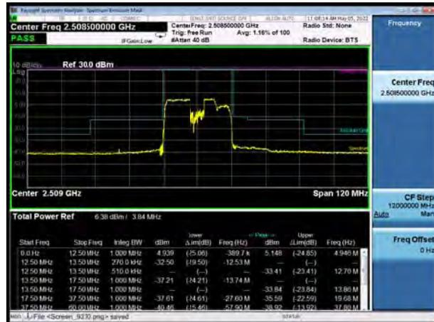
CA\_41C 16QAM 20MHz+5MHz CH- High, 100%RB
