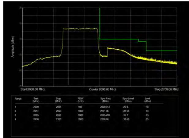
LTE Band 41 16QAM 10MHz CH-Low, 1 RB
