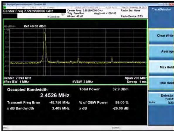
DC\_28 A (subset 2)-n41A QPSK 1RB 100MHz
