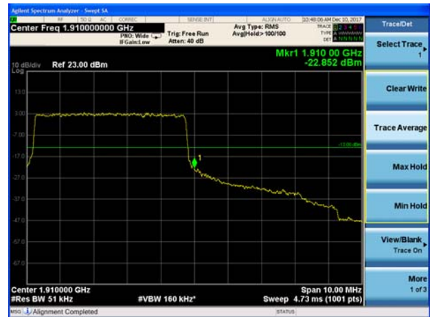
LTE Band 2 10MHz QPSK 1RB CH-High
