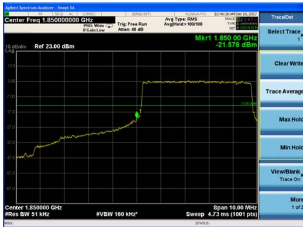
LTE Band 2 10MHz QPSK 1RB CH-Low
