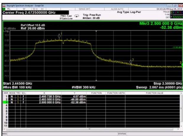
,Plot 2,Band Edge-802.11n(HT20) ,2462MHz,Ant0
