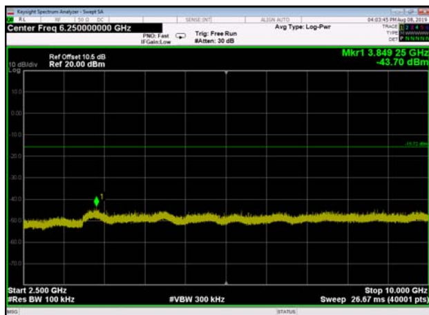
,Plot 4,2500MHz~10000MHz-802.11n(HT20 ) ,2437MHz,Ant0
