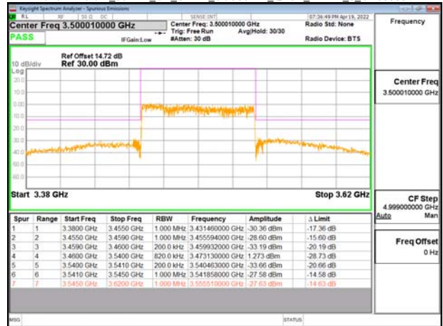
Band77-Part27_80MHz_CP_OFDM_SCS30kHz_QPSK_RB217_0_CH633334
