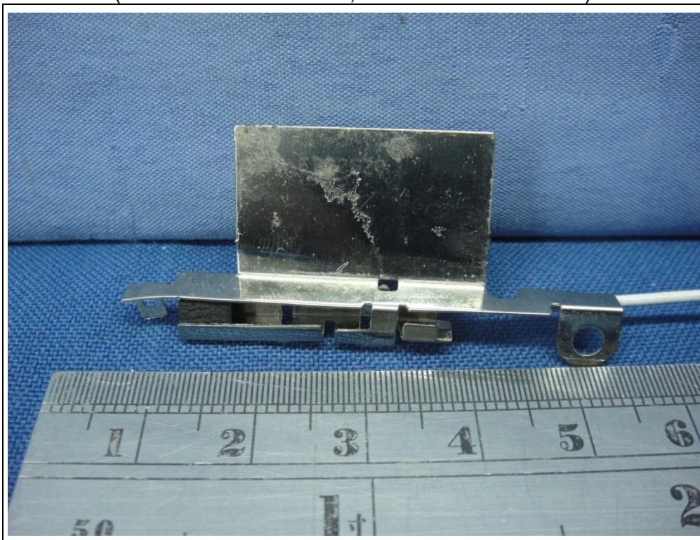
Antenna set 1 (Chain 1 / Brand : WNC, Model : 81-EBJ15.005)
