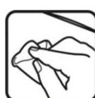
Nettoyer régulièrement la cavité située sous l'unité émettrice dans les modèles avec la recharge à induction pour éliminer l'éventuelle accumulation de sédiments.
