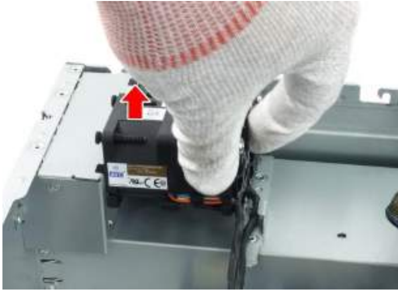
Figure 76 Remove Side Fan
