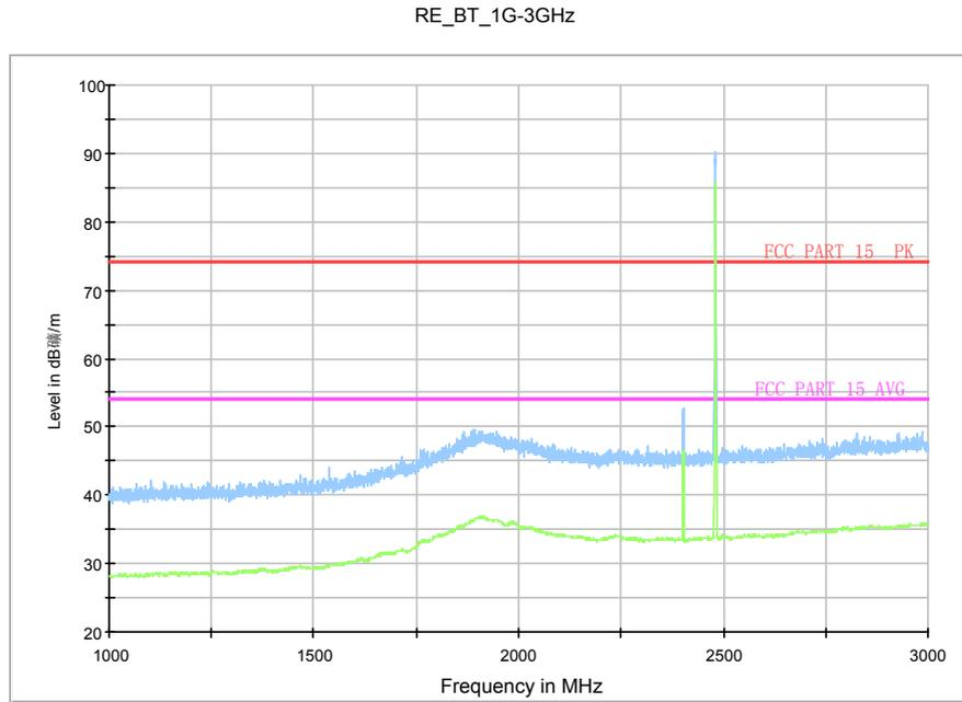
Fig.73. Radiated emission:  $\pi/4$  DQPSK, Channel 78, 1 GHz - 3 GHz
