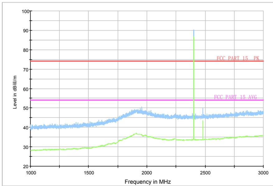
Fig.68. Radiated emission:  $\pi/4$  DQPSK, Channel 0, 1 GHz - 3 GHz
