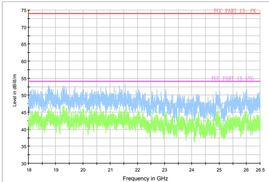
Fig.77. Radiated emission:  $\pi/4$  DQPSK, 18 GHz - 26 GHz
