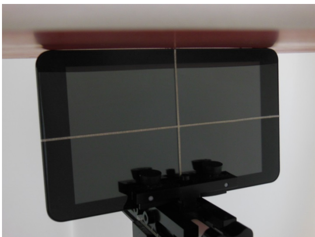
Edge 4 with Phantom 0 cm Gap
