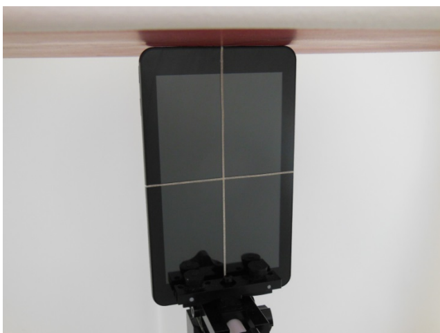
Edge 1 with Phantom 0 cm Gap
