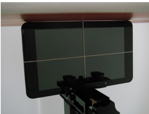
Edge 2 with Phantom 0 cm Gap
