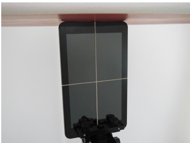
Edge 3 with Phantom 0 cm Gap
