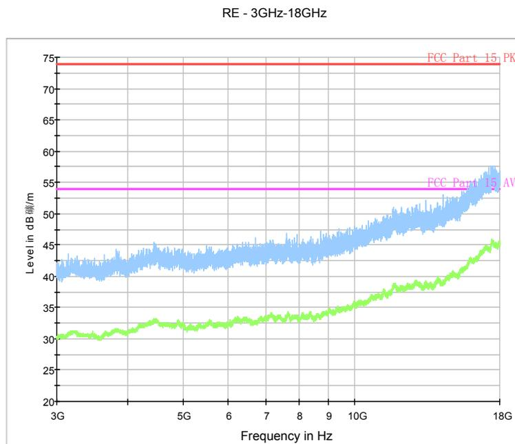
Fig.75. Radiated emission:  $\pi/4$  DQPSK, Channel 39, 3 GHz - 18 GHz
