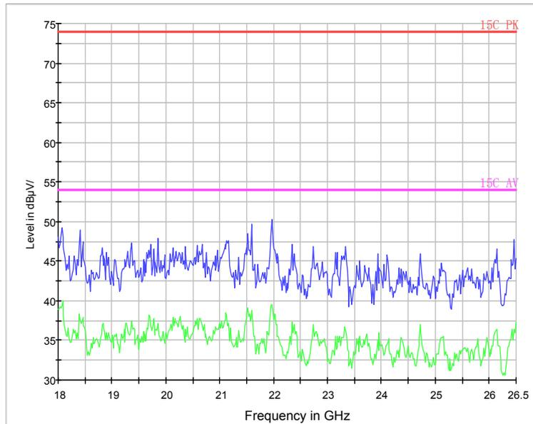
Fig.81. Radiated emission:  $\pi/4$  DQPSK, 18 GHz - 26 GHz
