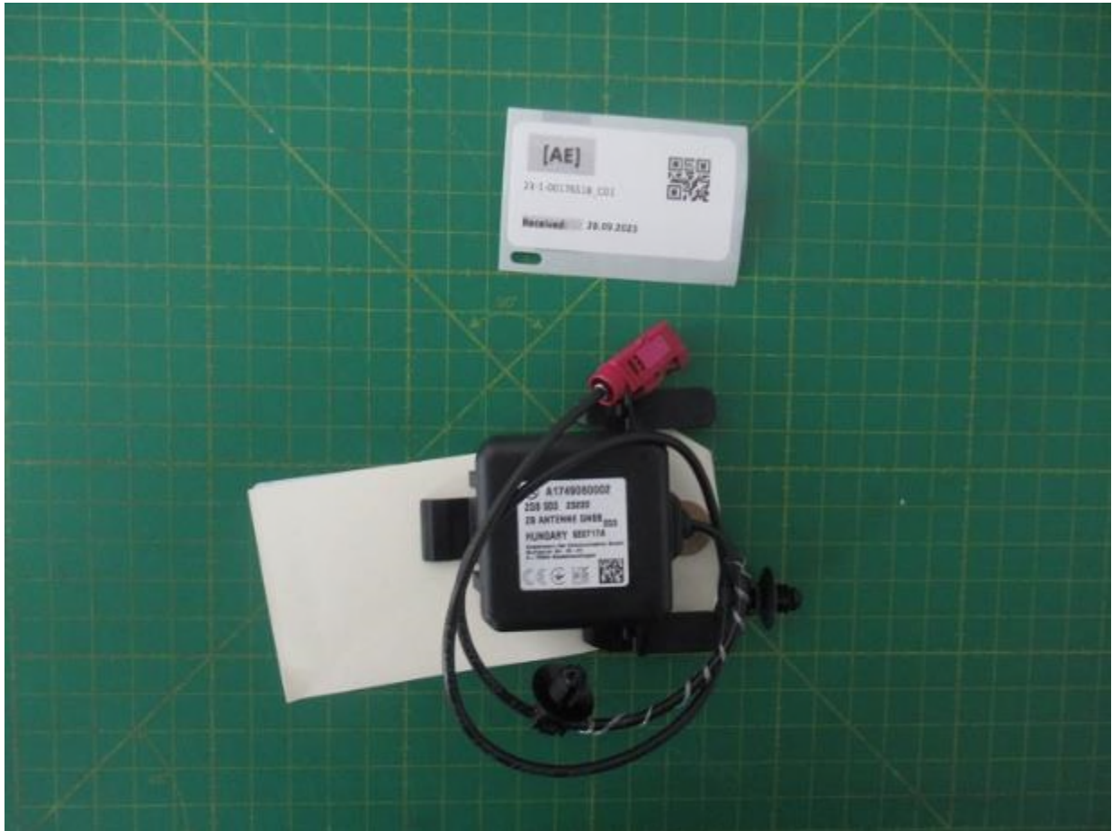
Fig. Ext.: 5 : Ext. - Front external GNSS antenna
