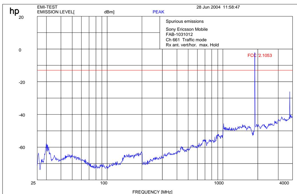
$f < 1 \text{ GHz} : \text{RBW/VBW: } 100 \text{ kHz}$  $f \geq 1 \text{ GHz} : \text{RBW / VBW } 1 \text{ MHz}$
