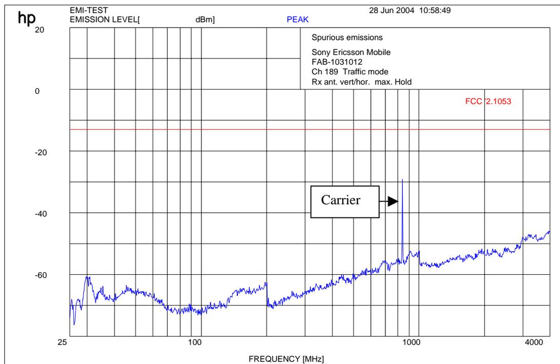
$f < 1 \text{ GHz} : \text{RBW/VBW: } 100 \text{ kHz}$  $f \geq 1 \text{ GHz} : \text{RBW/VBW } 1 \text{ MHz}$
