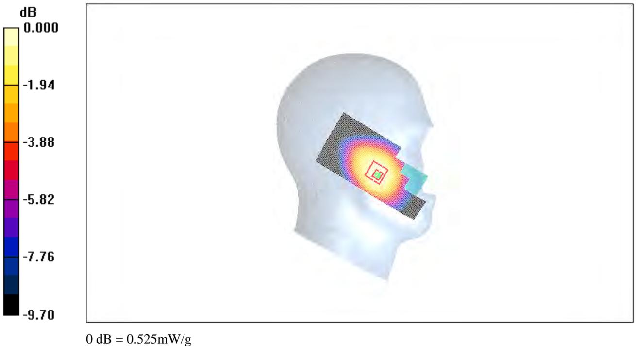
**Fig. 7 850 MHz CH128 – Slide up**
