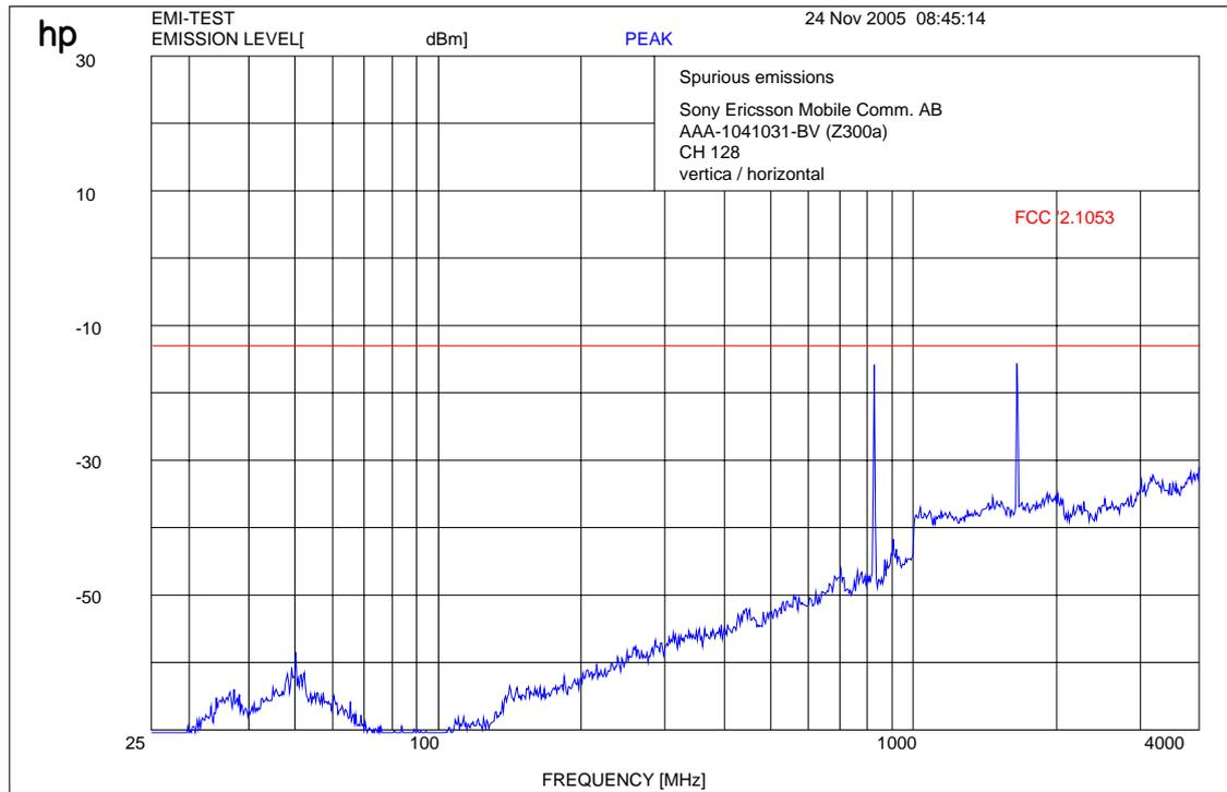
$f < 1 \text{ GHz} : \text{RBW/VBW: } 100 \text{ kHz}$
