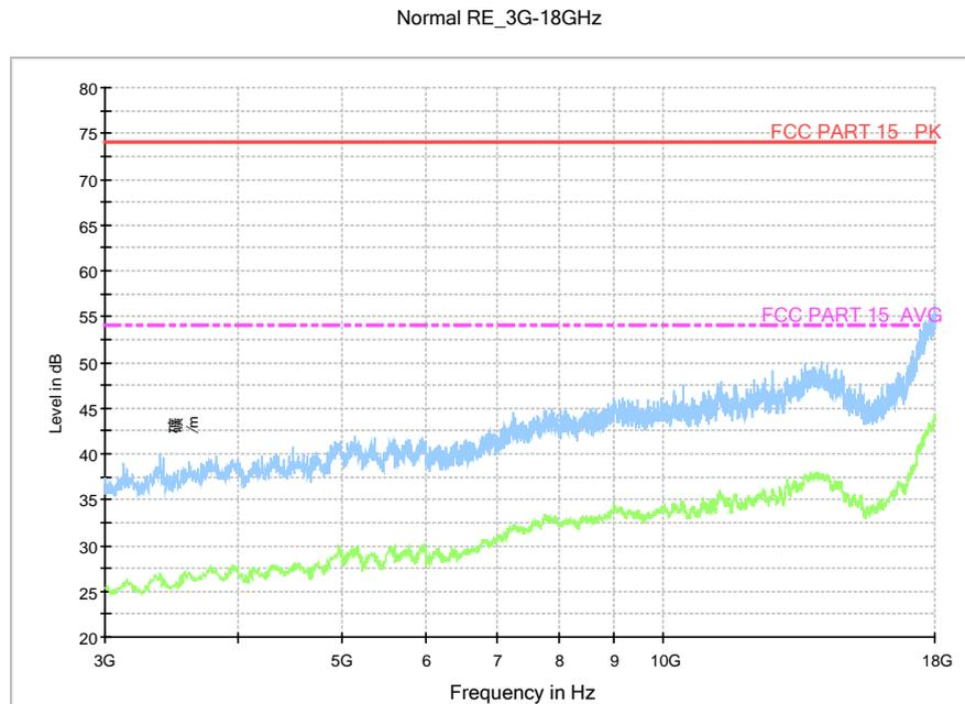
Fig.51. Radiated emission:  $\pi/4$  DQPSK, Channel 0, 3 GHz - 18 GHz
