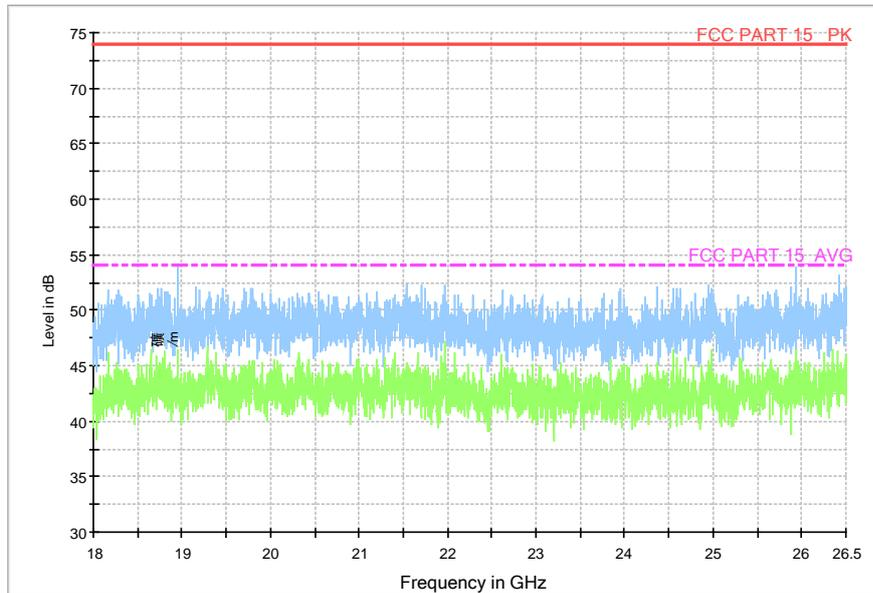
Fig.59. Radiated emission:  $\pi/4$  DQPSK, 18 GHz - 26 GHz
