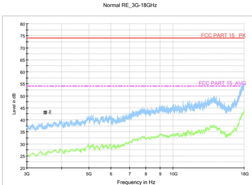
Fig.56. Radiated emission:  $\pi/4$  DQPSK, Channel 78, 3 GHz - 18 GHz
