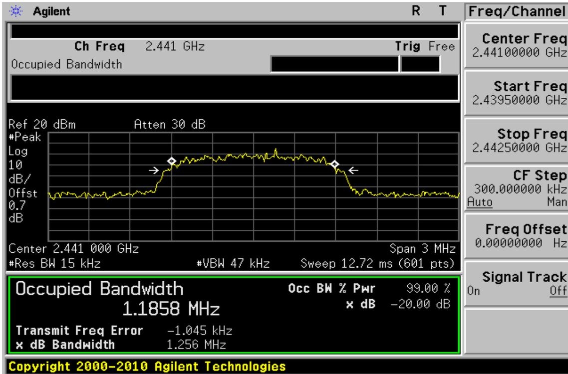
20dB Band Width Test Data CH-High ( /4-DQPSK mode)
