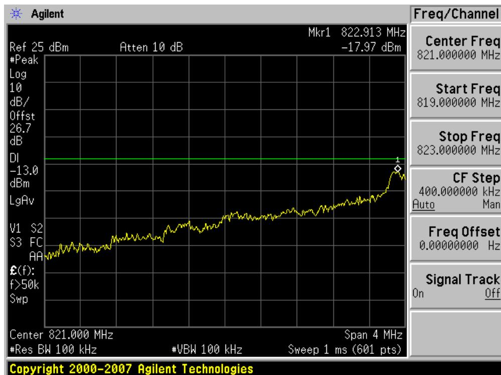
■ CDMA MODE (777 CH.) 4 MHz Span -Block Edge
