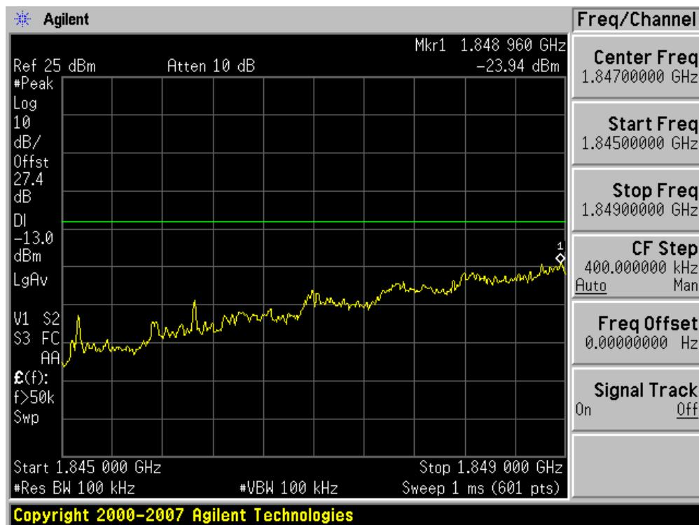
■ PCS CDMA MODE (1175 CH.) 4 MHz Span -Block Edge
