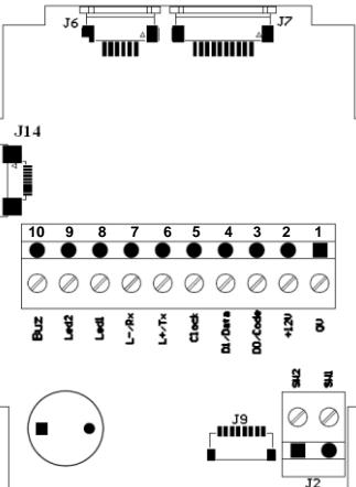
J6 : Connecteur antenne / Antenna connector
